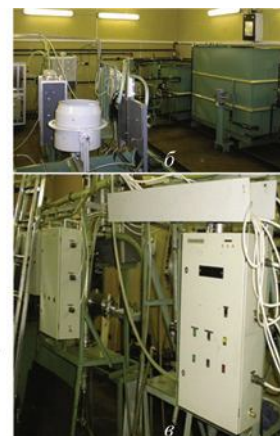
Рис. 7. Принципиальная аппаратурно-технологическая схема переработки нефтесодержащих грунтов с использованием УЗ техники (а); общий вид стенда (б); УЗ генератор MUG 10/20-27 (в)
