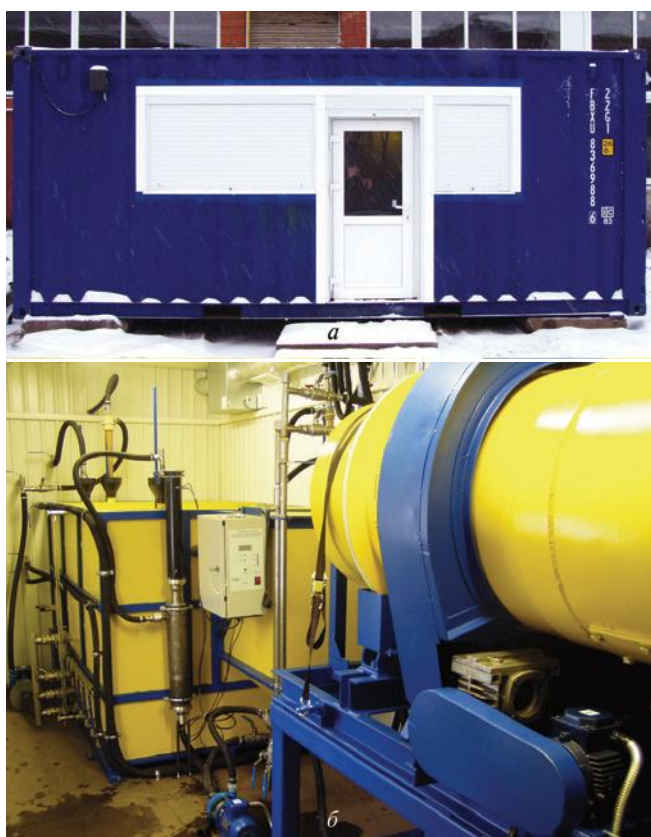
Рис. 6. Мобильный комплекс ультразвуковой гальванокоагуляционной очистки загрязненных вод: а – общий вид контейнера; б – блочно-модульная установка
