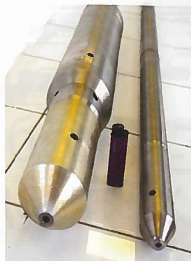
РИС. 4. СКВАЖИНЫЕ ПРИБОРЫ ДИАМЕТРОМ 42 И 102 ММ
