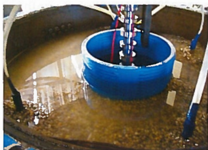
РИС. 3. БАРОКАМЕРА, МОДЕЛИРУЮЩАЯ КОНСТРУКЦИЮ СКВАЖИНЫ, С ГИДРОФОНАМИ
